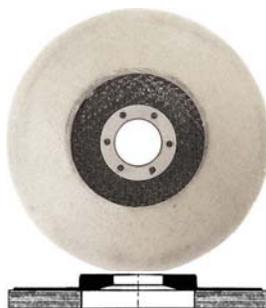
Con foro mm 22. Adatti per le più comuni smerigliatrici, lucidatrici ecc. In feltro di lana. Per pulire e lucidare a specchio metalli, rame, ottone, alluminio, acciaio INOX ecc. Da usare in combinazione con paste abrasive (Art. 1834 A - 1834 B - 1834 D). Velocità giri/min 6100. A profilo piatto e supporto in fibra di vetro.
